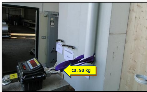
Vertikale Belastung einer Holzschraube (10 mm) in 20 cm Dämmstärke, Lastabstand ca. 20 mm = 105 \text{ kg}
