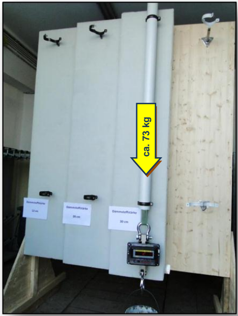
Vertikalbelastung eines Ablaufrohres auf 2 Rohrschellen in 30 cm Dämmstärke = 73 \text{ kg}/2 = 36 \text{ kg/RSH}
