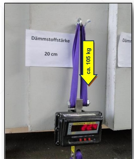
Vertikale Belastung einer Holzschraube (10 mm) in 20 cm Dämmstärke, Lastabstand ca. 20 mm = 105 \text{ kg}
