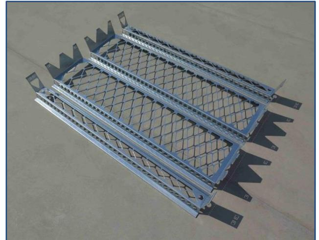
Erforderliche saniflex-Module in den Nennbreiten 110, 220 und 330 mm zusammenstellen. Die Module werden vor dem Einbau in den Aufsatzkranz auf einer ebenen Fläche aufgelegt und in den Falzen zusammengeschoben und zu einem Gitterkorb verbunden.
